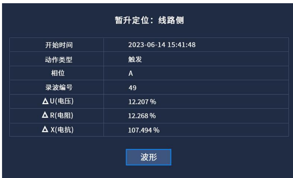
图 4.27(b) 电压暂升源定位-线路侧
