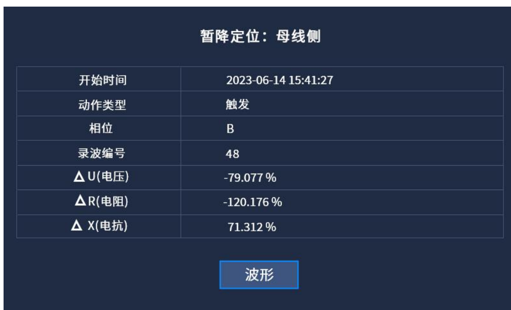
图 4.27(a) 电压暂降源定位-母线侧
