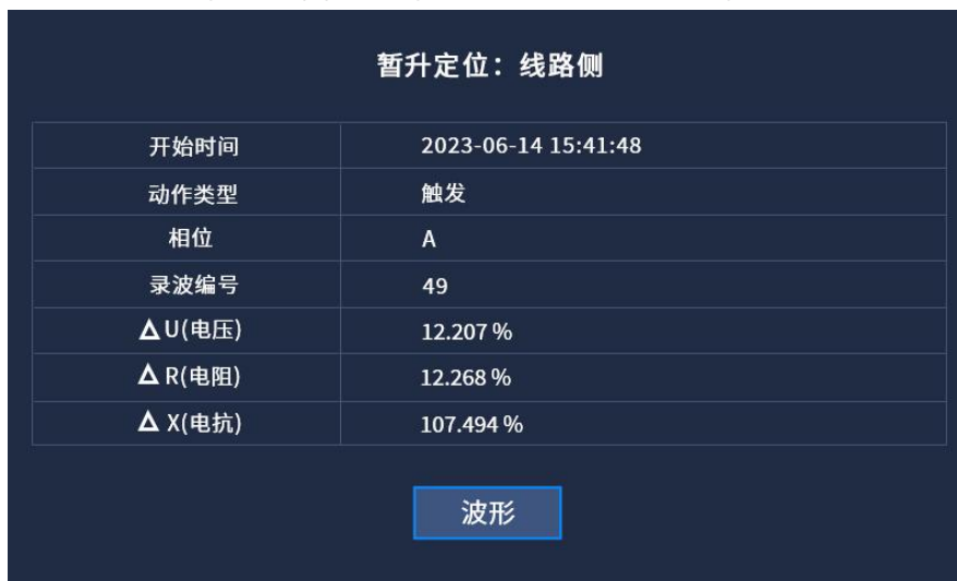
图 4.25(b) 电压暂升源定位-线路侧
